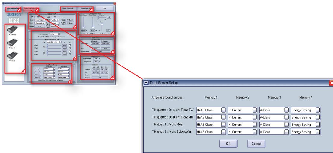
Questo setup consente di gestire in maniera completa la modalità di funzionamento degli amplificatori presenti nel sistema. Lo schema presenta in maniera organica il nome dell'amplificatore e i canali su cui si sta intervenendo. E' possibile agire sui menù a tendina creando delle memorie specifiche per le diverse modalità di funzionamento.
