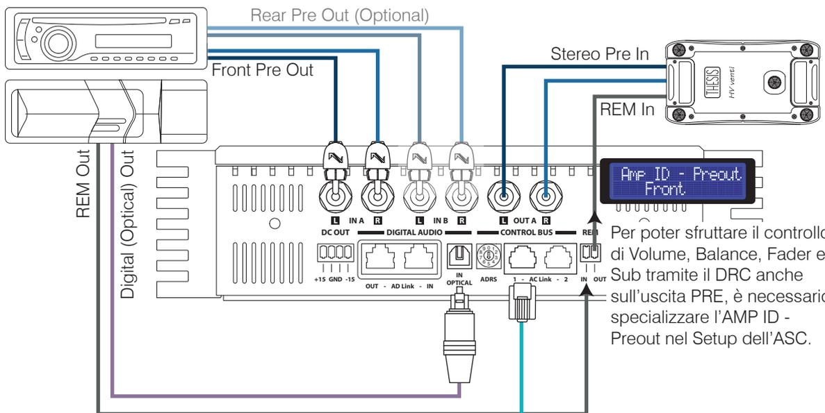
Per poter sfruttare il controllo di Volume, Balance, Fader e Sub tramite il DRC anche sull'uscita PRE, è necessario specializzare l'AMP ID - Preout nel Setup dell'ASC.
