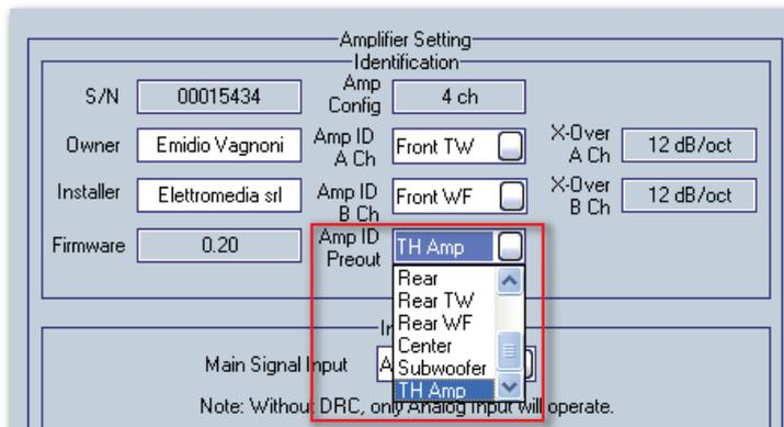
Se il sistema è composto anche da amplificatori non TH, sarà comunque possibile gestirli, assegnando un ID all'uscita PRE a loro connessa. Di default il sistema propone la voce TH Amp in quanto presuppone che anche all'uscita PRE sia connesso un amplificatore TH (già dotato quindi di un suo Amp ID specifico).
