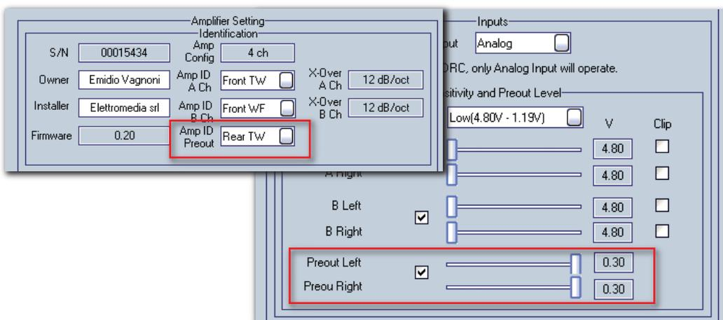
Quando si assegna un ID anche al Preout, poichè magari vi è collegato un amplificatore non-TH e lo si vuole comunque controllare con il DRC, si avrà la possibilità di gestirne anche la sensibilità d'uscita dal TH. I relativi slider appariranno solo se alla voce Amp ID Preout ci sarà una voce diversa da TH Amp.
