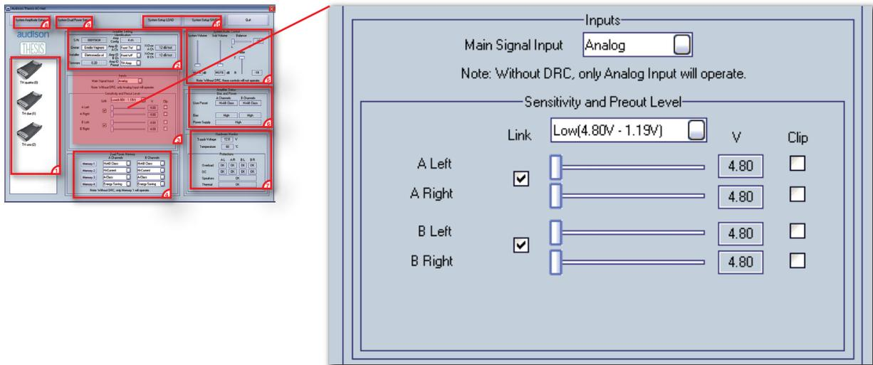
Così come nel Setup Amplifier dell'ASC è necessario specializzare il sistema qualora si intenda utilizzare l'ingresso digitale, in questa schermata occorre selezionare il tipo di ingresso principale, per ogni amplificatore connesso al sistema.
