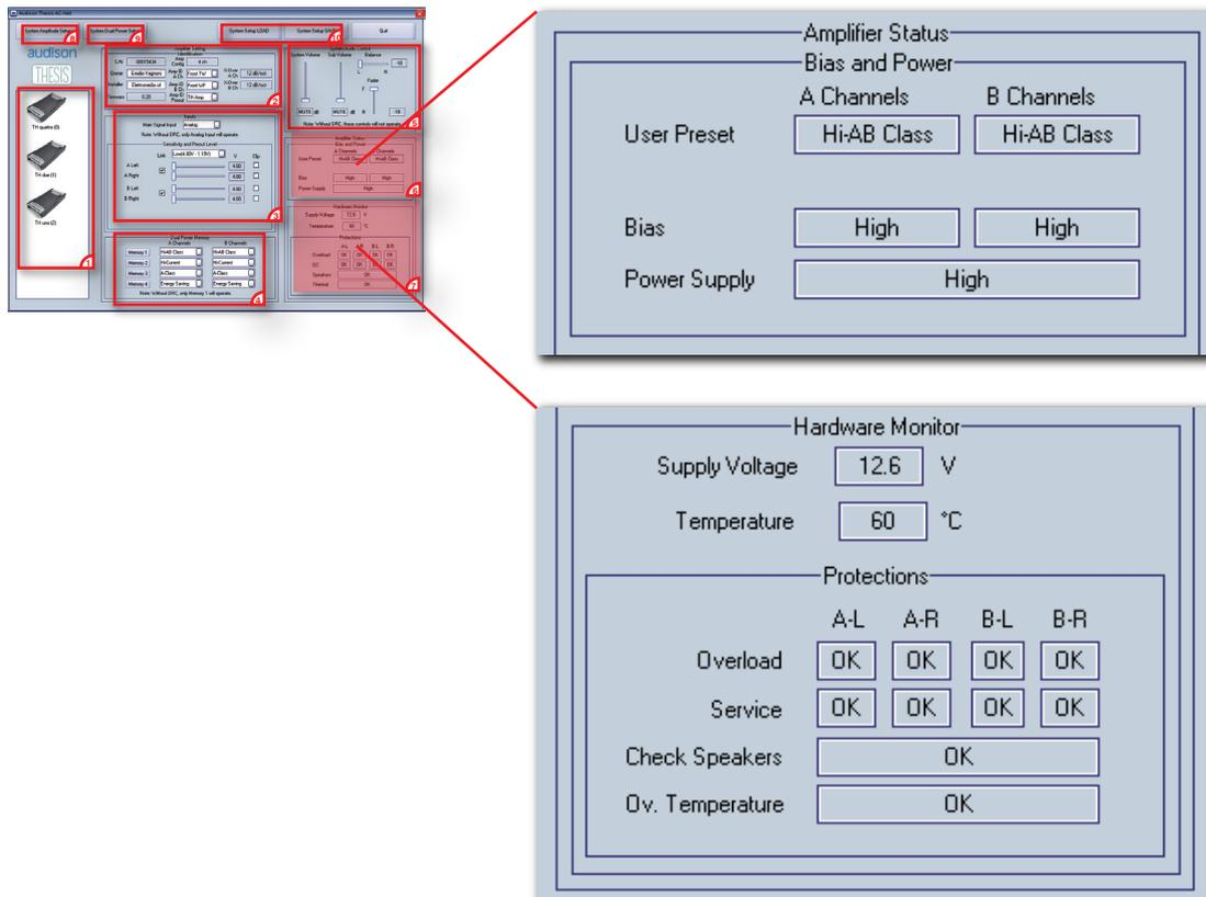
Il software ACNet esegue un controllo in tempo reale delle condizioni di lavoro degli amplificatori. Una volta selezionato un amplificatore vengono riportati negli specifici campi i parametri monitorati dall'ASC presente sul singolo amplificatore.
