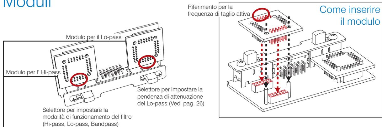
Modulini per il taglio di frequenza: sono utilizzabili sia nella posizione Hi-pass che nella posizione Lo-pass
