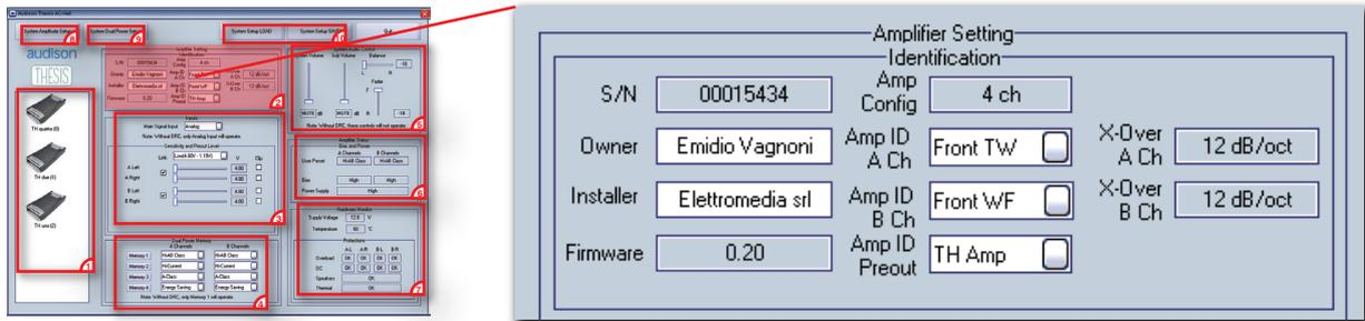
L'identificazione dell'amplificatore prevede che sia riportato il suo S/N - serial number (non modificabile), il nome del proprietario (editabile), il nome dell'installatore (editabile) e la versione del Firmware presente nel microprocessore a bordo dell'amplificatore TH.
