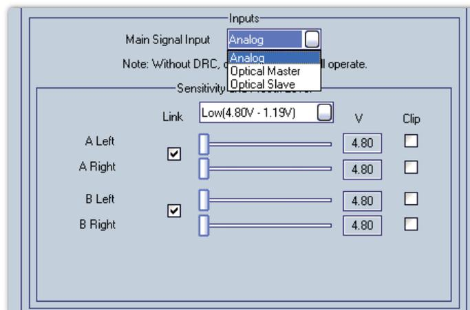
La nota avvisa che se al sistema non è collegato il DRC, anche se si seleziona un ingresso digitale, nel momento in cui si disattiverò il software ACNet, a funzionare sarà solo l'ingresso analogico.
