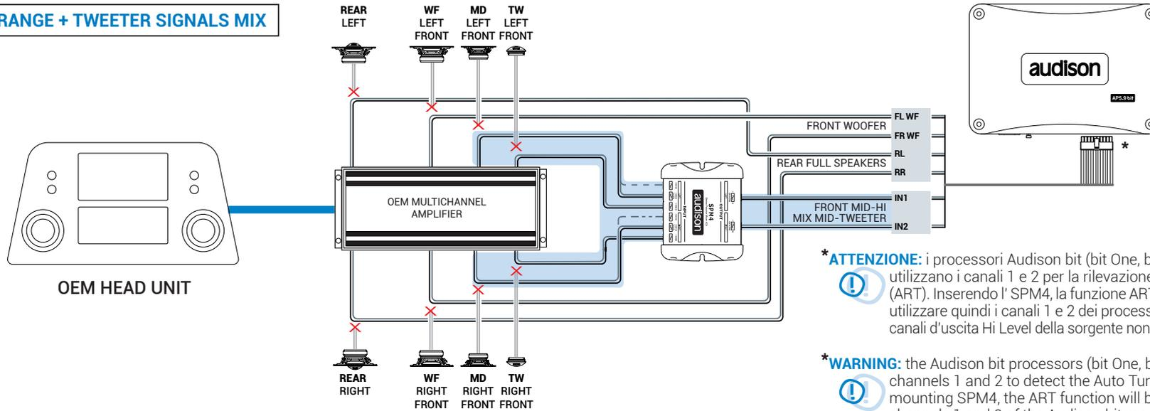
**\*ATTENZIONE:** i processori Audison bit (bit One, bit Ten, AP bit), utilizzano i canali 1 e 2 per la rilevazione dell'Auto Turn On (ART). Inserendo l' SPM4, la funzione ART non sarà più attiva; utilizzare quindi i canali 1 e 2 dei processori Audison bit sui canali d'uscita Hi Level della sorgente non connessi all' SPM4.
